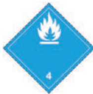
Stoffe, die in Berührung mit Wasser entzündbare Gase entwickeln
